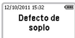
No se ha alcanzado el volumen de aliento o se interrumpió. Pulse el inicio
