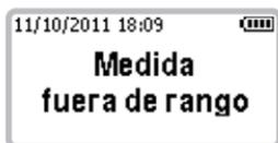
La concentración medida de alcohol excede el rango operativo del instrumento. Reinicie la prueba pulsando el botón inicio
