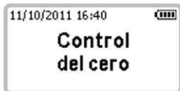
Se activa la bomba de muestreo para limpiar la cámara de medición.
