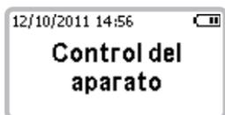
Si se valida la muestra de aliento, se verifica el funcionamiento adecuado del instrumento.
