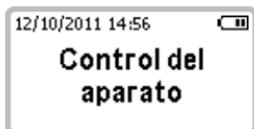
Si se valida la muestra de aliento, se verifica el funcionamiento adecuado del instrumento.
