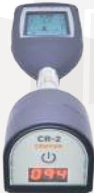
CR-2 acoplado ao sonómetro Octava-plus con nivel de presión sonora a 94 dB
